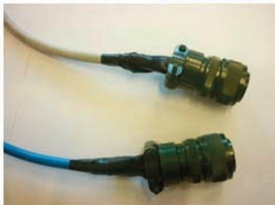
*ES IST NOTWENDIG, DEN HINTEREN TEIL DER ANSCHLÜSSE VOM EVENTUELLEN EINDRINGEN VON FEUCHTIGKEIT BZW. SCHMUTZ MIT ISOLIERBAND ODER WARMSCHRUMPFSCHLAUCH ZU BESCHÜTZEN.*
