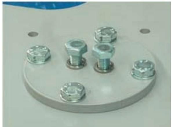
*POSITIONIEREN SIE DAS AGGREGAT STERN-NABE AN DIE ANTRIEBSWELLE
