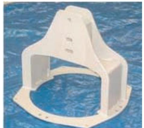
*DREHEN SIE DIE SCHRAUBEN ZUR BEFESTIGUNG DES BÜGELS AM MOTOINVERTER HER-AUS*
