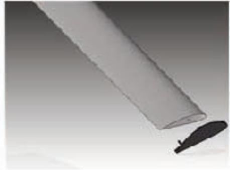
*Drehen Sie die Schraube, die das Winglet aus Plastik mit dem Flügel zusammenhält, heraus.*
