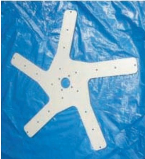
*Stern mit 5 Radspeichen zur Befestigung der Flügel*
