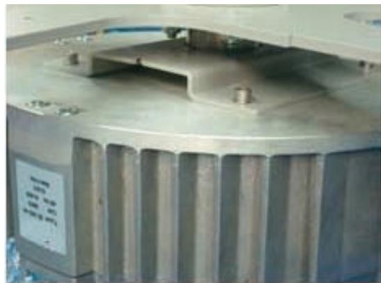
*POSITIONIEREN SIE DIE ANTI-FALL-PLATTEN UND ZIEHEN SIE MIT DEN SCHRAUBEN AN (die Schrauben sind bereits an dem Motor zu finden)*
